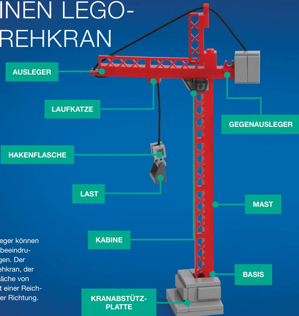
Dank der ausladenden Ausleger können Kranführer Lasten auf einer beeindruckend großen Fläche bewegen. Der größte freistehende Turmdrehkran, der Kroll K-10000, deckt eine Fläche von sechs Fußballfeldern ab, mit einer Reichweite von 100 Metern in jeder Richtung.
